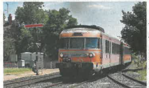
Un Turbotrain RTG équipé d'une turbine Turboméca.
